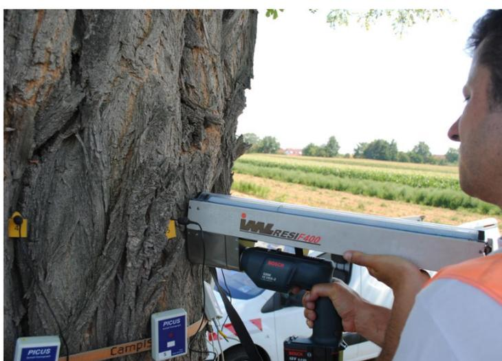
Bertrand Morin utilise le résistographe en dernier recours. Ce dernier livre une courbe qui permet de se rendre compte de la résistance du bois.
